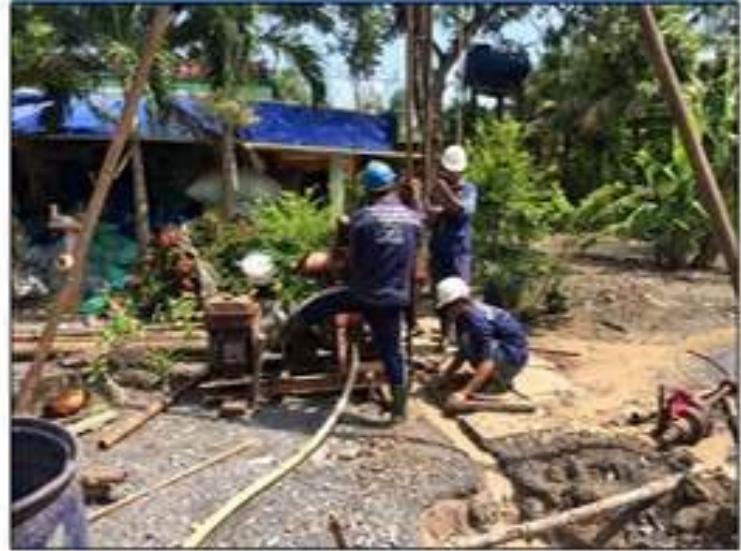
Thi nghiệm kiểm tra độ thẳng đứng bộ khoan KODEN
