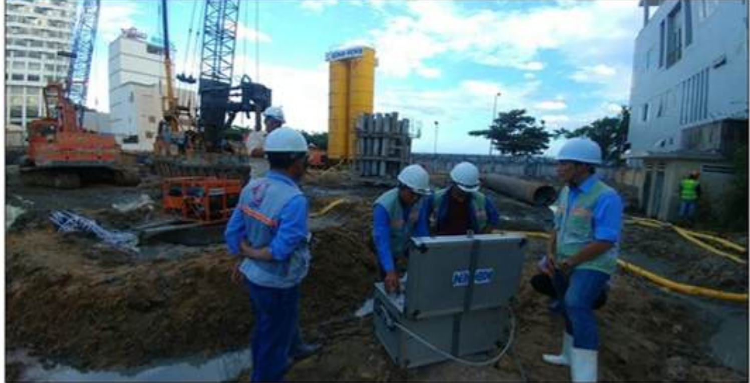
Thi nghiệm khoan kiểm tra tiếp xúc mũi cọc và đất
