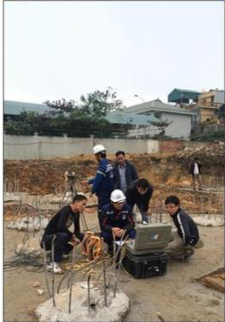
Thi nghiệm sửa âm cọc khoan nhồi SONIC
