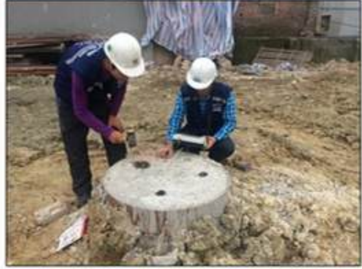
Thi nghiệm kiểm tra độ thẳng đứng bộ khoan KODEN
