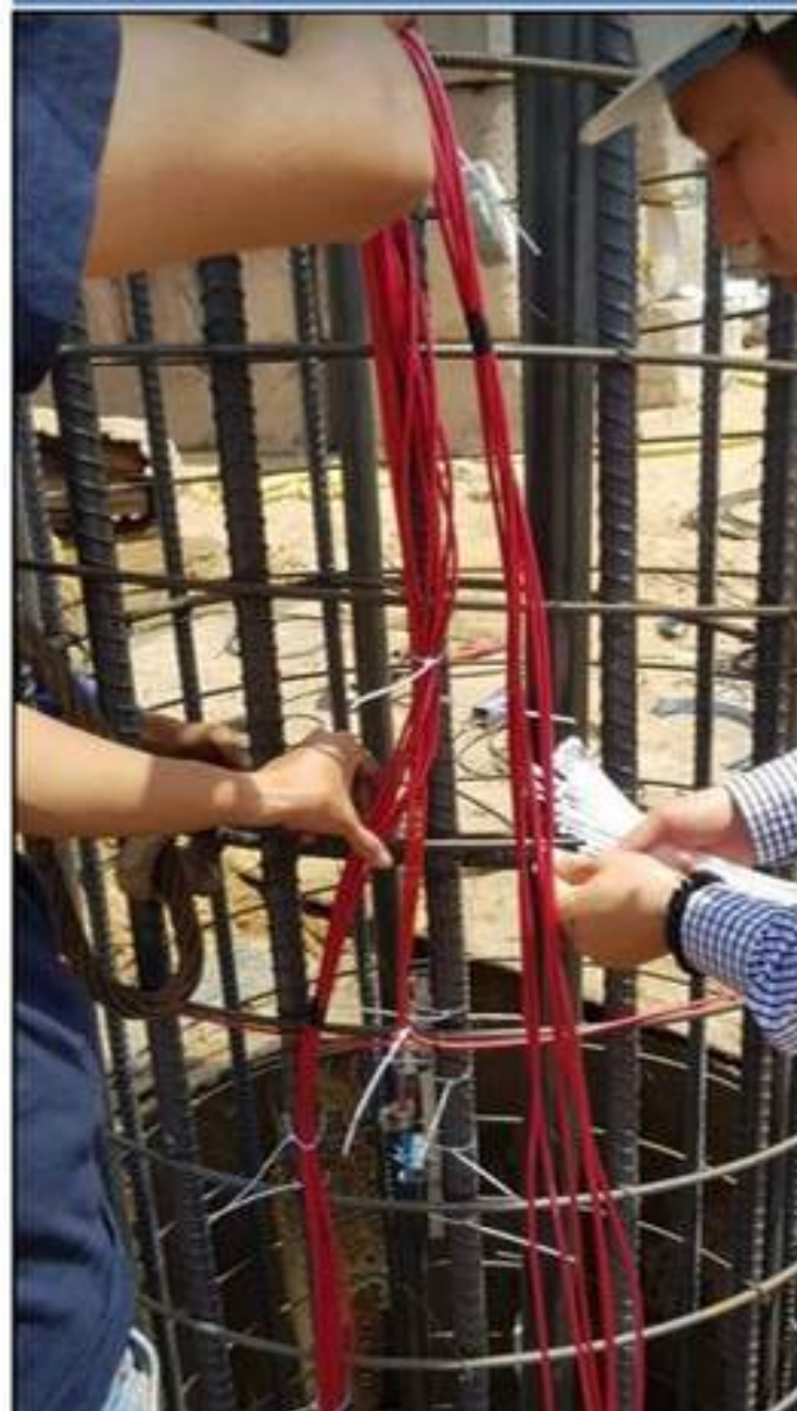
Thí nghiệm đo ứng suất thân cọc StrainGause
