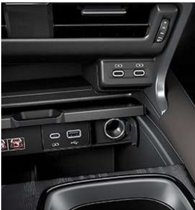
Bảng điều khiển trung tâm: 3 cổng sạc USB Type C, cổng giao tiếp đa phương tiện USB Type A, nguồn DC12V
