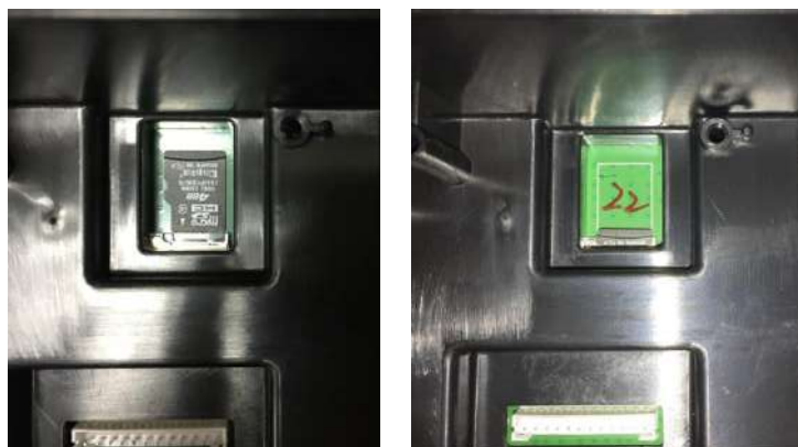
Figura 2-5 Instalando una tarjeta SD en una entrada para SD (izquierda); tarjeta SD instalada (derecha)
