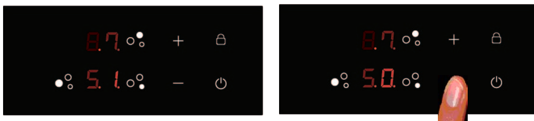
Hình 9: Lựa chọn công suất cho vùng nấu
