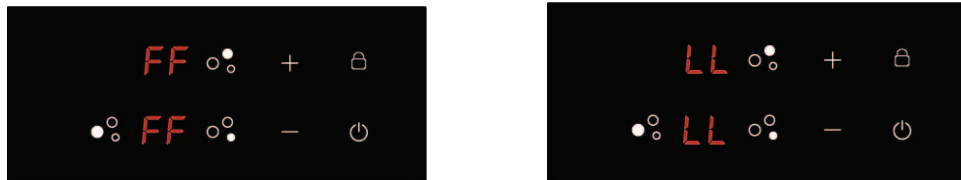
Hình 1: Lỗi ánh sáng môi trường xung quanh cảm biến hồng ngoại
