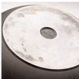
Oxi hóa đáy chảo (khi dùng máy rửa bát). Đây là quá trình ô xi hóa nhôm không gây hại.
