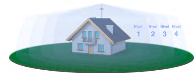
Fig. 4 – ESE protection volume.
