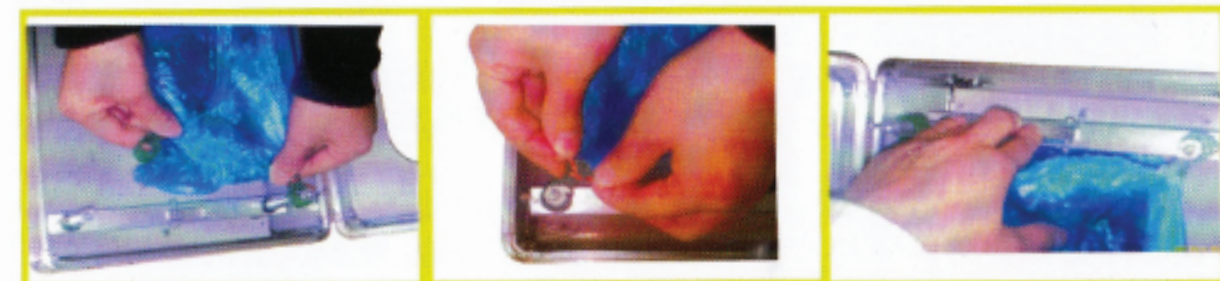
Bước 5 Tháo dây buộc trên 4 vòng của các đôi giày ra, sau đó chỉnh vòng tròn của giày lắp vào trụ cho chắc chắn
